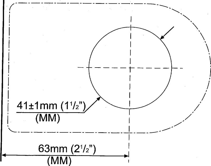
Porauskaavio kiinnitetään suljetun oven sisäpuolelle.
